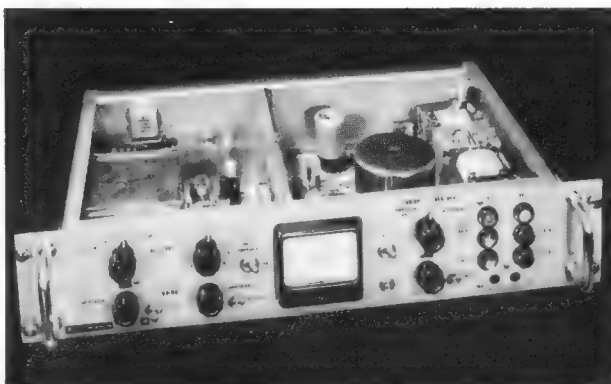
Bild 16. Transistorisierte Steuerstufe für UKW-Rundfunksender mit 13 Transistoren, 13 Dioden und einem Quarz
